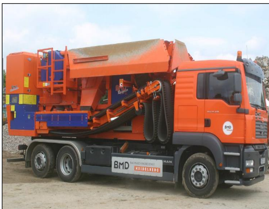
Figura 103 - Usina móvel de RCC.
