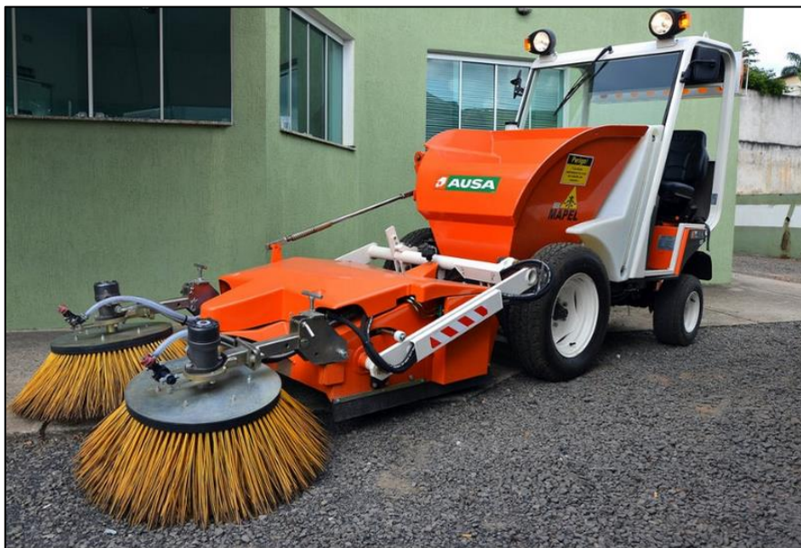
Figura 100 - Equipamento utilizado para varrição mecânica.
