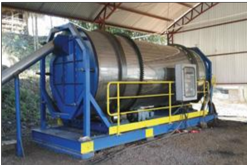
Figura 98 - Reator de compostagem acelerada.
